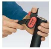
Установка инструмента для продольного реза
