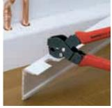
Специальные кпещи для особых задач, таких, как краевая вырубка различных материалов или пробивка в них отверстий (высечные клещи, клещи для пробивания кафельной
