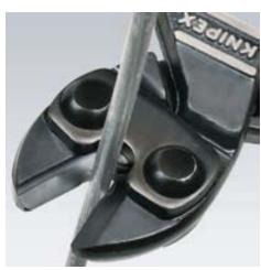
71 31/32/41 200: Благодаря расположению выемки в режущих кромках в непосредственной близости от шарнира, толстая проволока фиксируется в удобном для резки положении (оптимальное соотношение плеч рычага).
