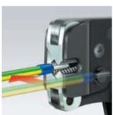
97 53 08: параллельное введение контактных гильз сбоку до 2,5 мм²
