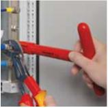
Процесс настройки на деталь с KNIPEX Cobra® VDE выполняется просто и надежно: наложите открытые клещи верхней захватной губкой на деталь, закройте клещи, готово!
