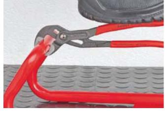
Смещенные против направления вращения зубцы обеспечивают эффект самофиксации и предотвращают соскальзывание инструмента с детали.
