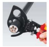
Принцип трещоточного ключа и двух ходовой шестеренчатый привод для резания с меньшим усилием
