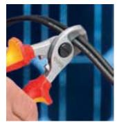
Рез кабеля ножницами для резкикабелей: малое усилие, аккуратный рез без деформации кабеля.
