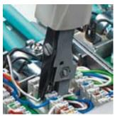
Опрессовка и резание кабеля в одной операции
