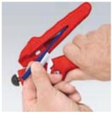
К монтажному инструменту прилагаются три шипообразных торпедных выступа для кабелей различного сечения
