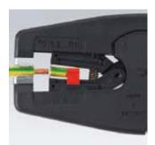
Прецизионное снятие изоляции толщиной от 0,03 до 10,0 мм² без последующей юстировки
