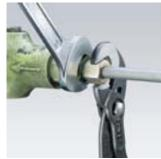
Клещи переставные гаечный ключ в качестве второго «ключа» для контрсоединений
