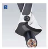
Повторите процесс резки и раскрытия инструмента, пока кабель не будет перерезан.
