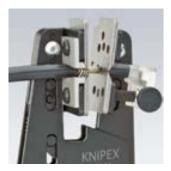
Автоматическое снятие изоляции
