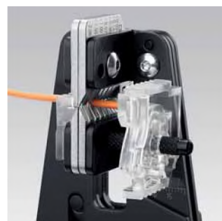
Ровное надрезание изоляции по всей окружности кабеля
