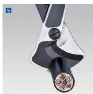
Повторите процесс резки и раскрытия инструмента, пока кабель не будет перерезан.
