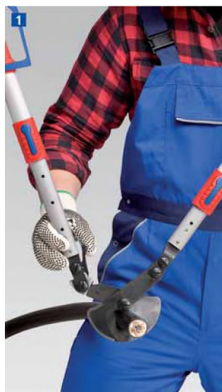
настройка удобного расстояния между ручками
