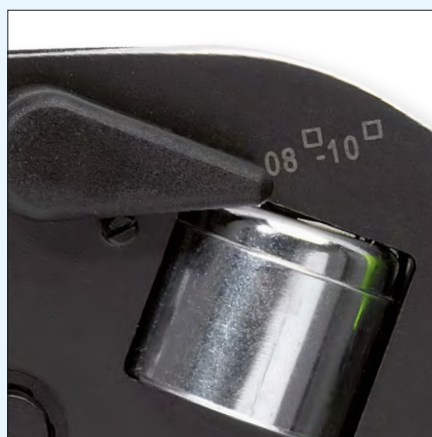
Переключение рабочего диапазона 0,08–16мм 2 , автоматическая настройка с помощью пружинного узла
