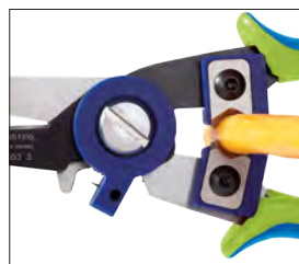
Удаление наружной оболочки с помощью заменяемых фасонных ножей
