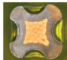
Поперечный разрез тетрагонального обжимного соединения Cross-section of a 4/8 indent crimp
