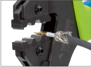
Обжим внутреннего сердечника Inner conductor crimp
